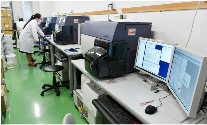
検査室には光センサーを用いて細胞を観察するFACS (Fluorescence activated cell sorter：蛍光活性化セルソーティング)が6台並ぶ。
